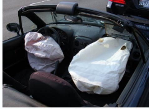
في هذه الصورة يمكننا أن نرى تفعيل الوسادة الهوائية للمقاعد، وهي تشابه أكياس الستائر التي يتم تنشيطها مع الاصطدام الجانبي. في بعض السيناريوهات قد تواجه العديد من عمليات تفعيل الوسائد الهوائية في المركبة التي تتعرض للاصطدام من عدة اتجاهات.
